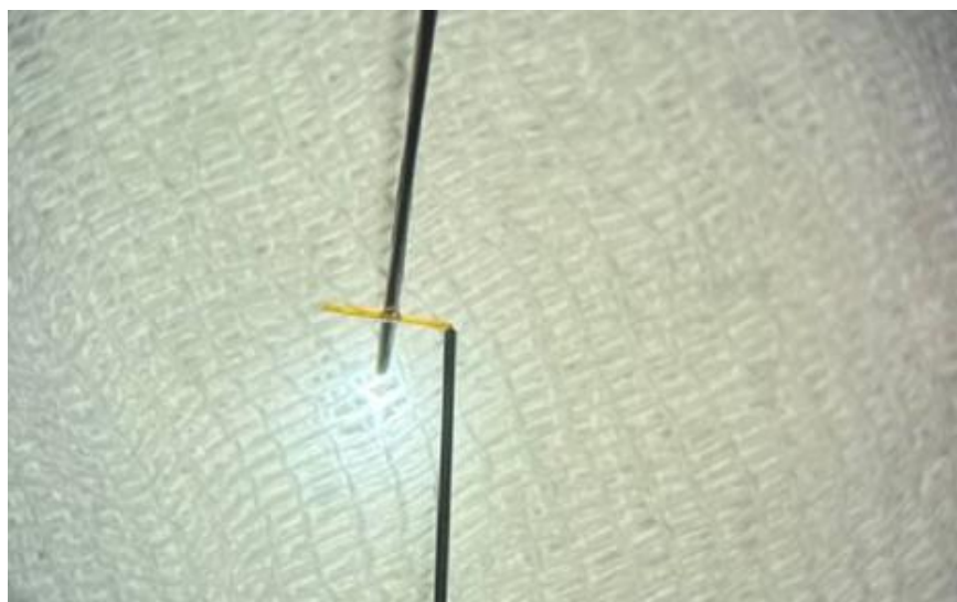
Рисунок 11. Гибкий кончик субретинальной канюли 25-38G
